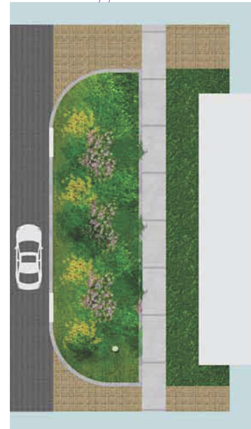
BOULEVARD BIORETENTION UNIT
